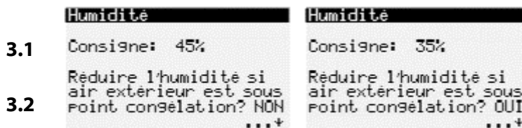
Figure 48 - Exemples d'options de réglages l'humidité et de la réduction automatique en hiver.
