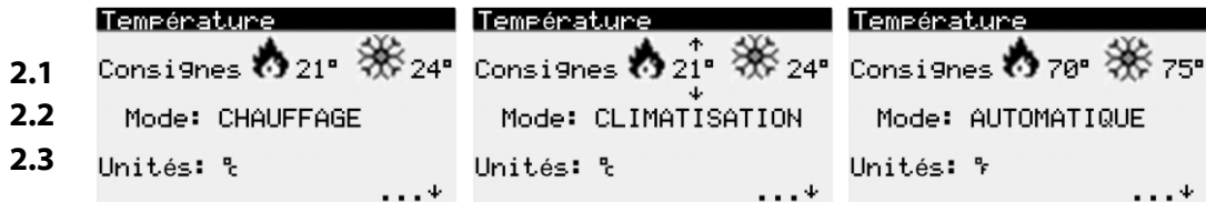
Figure 41 - Exemples d'options de réglages de la température de consigne, mode et unités.
