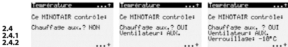
Figure 42 - Exemples d'options de chauffage auxiliaire (central).
