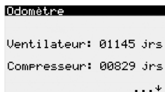
Figure 65 - Exemples d'information disponible dans l'écran « Infos système - odomètre ».
